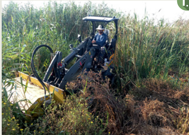
כיסוח סלקטיבי של קנה באמצעות טרקטור בעל מכסחת זרוע קדמית צילום: רונן כפיר
