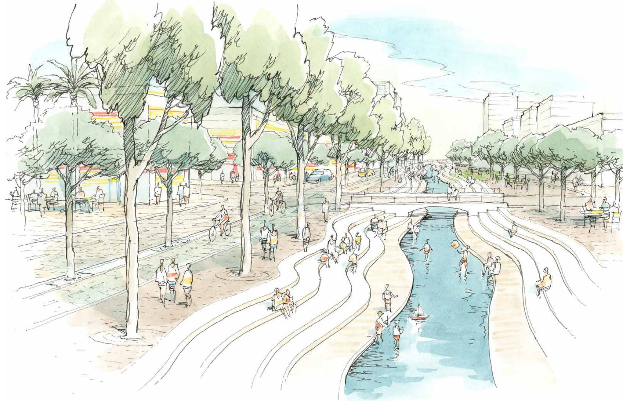
שדרה אורבנית | פירוק והפיכת מובל בטון עמוק מגודר ולא נגיש לערוץ עם גדות מדורגות כך שהנחל מהווה חלק אינטגרלי ממרחב הרחוב. תוך שימוש בחומרים המפורקים לחידוש הנחל וצמצום פסולת בנייה
