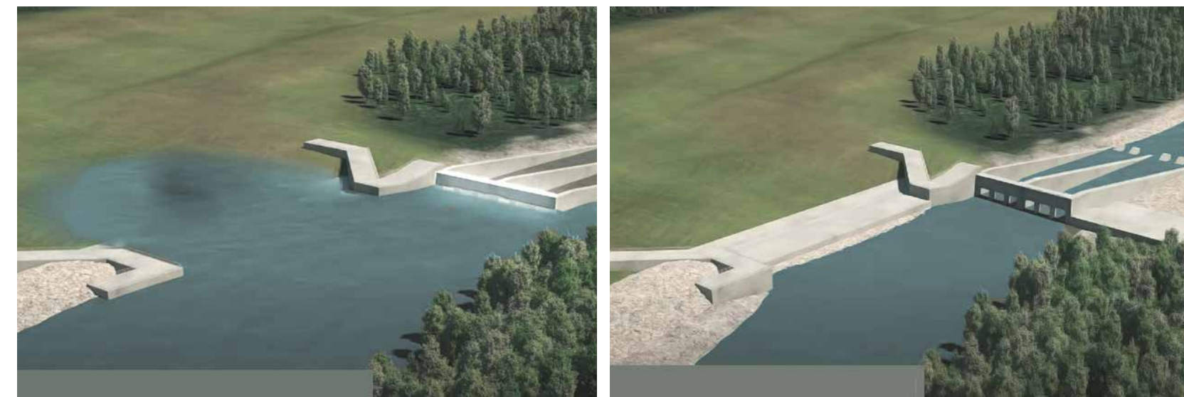
מצב נחל טיפוס | זרימת מים בערוץ הנחל דרך הסכרון מצב נחל בעת שיטפון | חלק מהמים ממשיך לזרום בערוץ וחלק מוטה הצידה לאגן השהיה זמני
